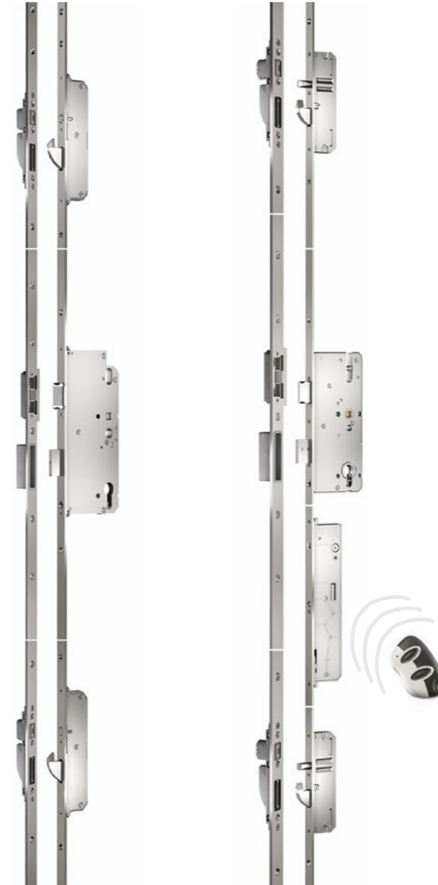
AUTOMATIKSCHLOSS ...mit selbstverriegelnden Schwenkhaken; an drei Punkten sicher verriegelt durch bloßes Zuziehen der Tür – ohne Schlüsselbetätigung!
